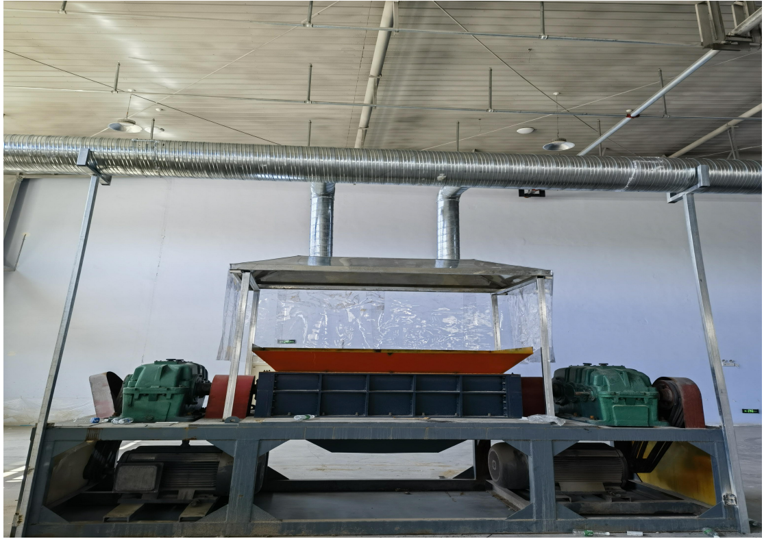
图 3-3 本项目集尘罩照片
